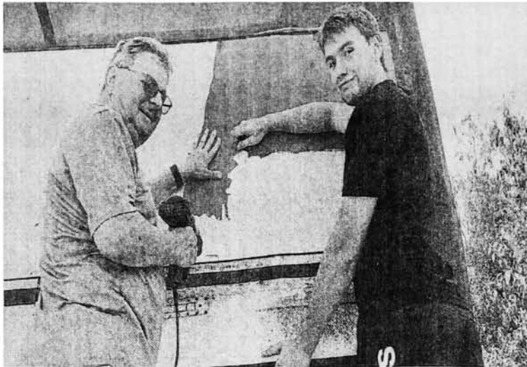
Mit Heißluft und Fingern entfernen Udo Wiesner (l) und Leon Cordes Stück für Stück die alte Folie vom TR07 beim Transrapid-Besucherzentrum in Lathen. Fotos: Gerd Schade
