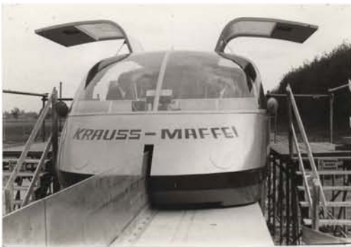
Der Transrapid 02 auf der Teststrecke. Die in der Mitte befindliche, senkrechte Schiene dient dem Antrieb durch den Linear-Motor. Foto Krauss-Maffei
