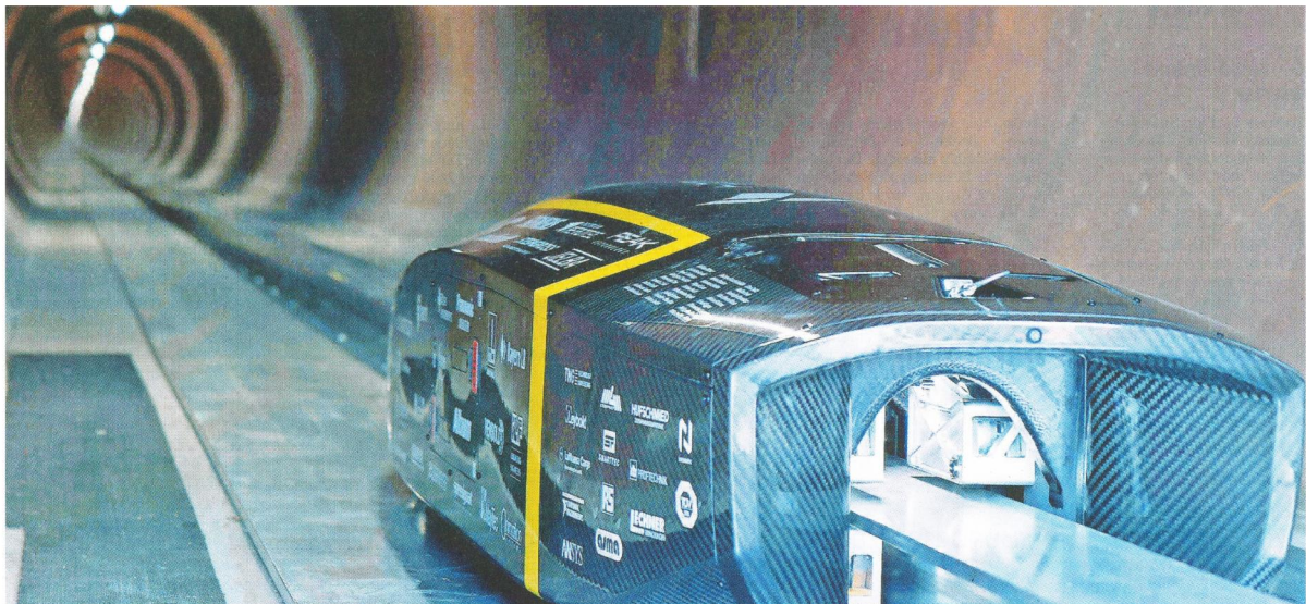
Rasen statt reisen: Die Transportkapsel der Technischen Universität München flitzt mit Tempo 482 durch die luftleere Röhre in Los Angeles.
