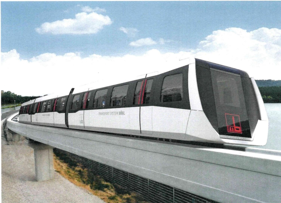
TSB Magnetschwebbahn ©Max Bögl
