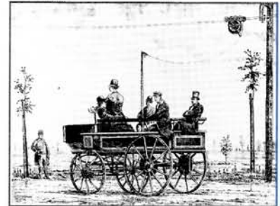
Die „Elektromotive“ des Werner von Siemens, 1882, der erste Oberleitungsbus der Welt. Quelle: Wikimedia Commons, public domain
