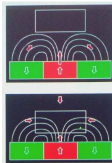
Abb. 1: Oben: Perfekter Diamagnet: Der Supraleiter wurde außerhalb des Magnetfeldes eingekühlt)
