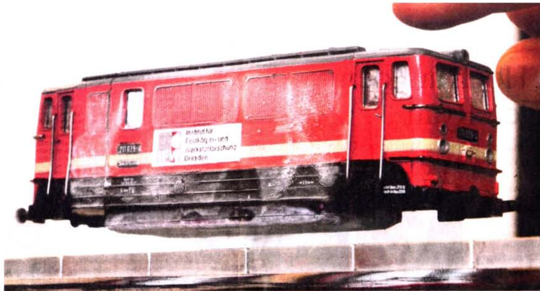
In diese Modelllokomotive ist ein Supraleiter eingebaut. Über einem Magneten kann diese Lok schweben. Supraleitertechnik könnte irgendwann den Verkehr revolutionieren
