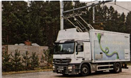
Mit Oberleitung: Testfahrt auf dem E-Highway
