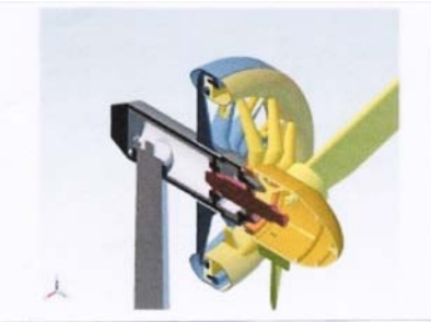
Magnetringgenerator Nahaufnahme (Quelle: Prof. Dr.-Ing. Siegfried Heier / Universität Kassel)
