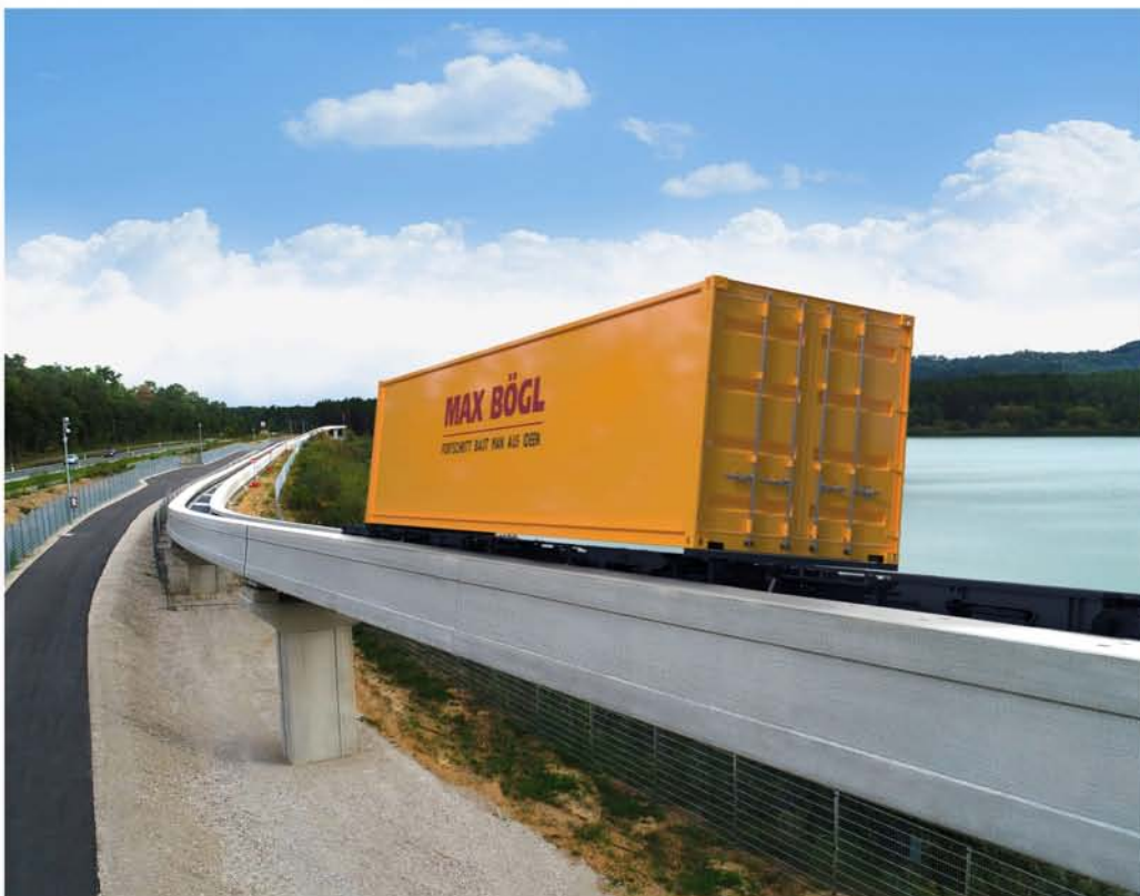
Wie auf dieser Teststrecke im bayerischen Sengenthal soll eine Magnetschwebbahn für Container durch den Hamburger Hafen fahren.
